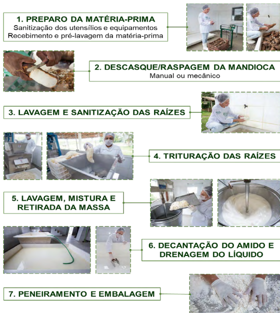
Figura 3: etapas da produção industrial da goma de tapioca. Fonte: Adaptado de SENAR (2018)
